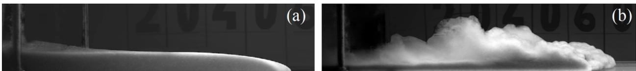
Suspensions de sédiments se propageant dans le canal. a- Coulées de boue. B-Courants de turbidité.
