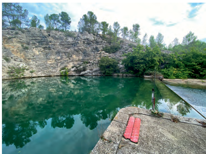
Photo 6: Source du Lez et mesure du niveau d'eau dans la vasque (Hérault). La hauteur d'eau au-dessus du déversoir à seuil épais permet d'estimer le débit s'écoulant à la source. À l'arrière-plan, les calcaires aquifères du crétacé inférieur (Berriasien) affleurent du fait du décalage associé à la « faille du Lez ». Cliché Hervé Jourde
